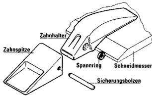
Nach dem Anschweißen des Halters am Schneidmesser wird die Zahnspitze auf die Halternase geschoben und mit einem Sicherungsbolzen und Spannring befestigt. Die Zahnspitze lässt sich beim Erreichen der Verschleißgrenze einfach und kostengünstig erneuern.
